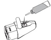
**Befüllen:** Die Nachfüllöffnung dieses Produktes ist kompatibel zu allen Nachfüllbehältern mit einem Ausgießdurchmesser von maximal 3 mm. Füllen Sie das eLiquid aus dem Nachfüllbehälter durch die Nachfüllöffnung bis maximal zur Oberkante des Tanks.
